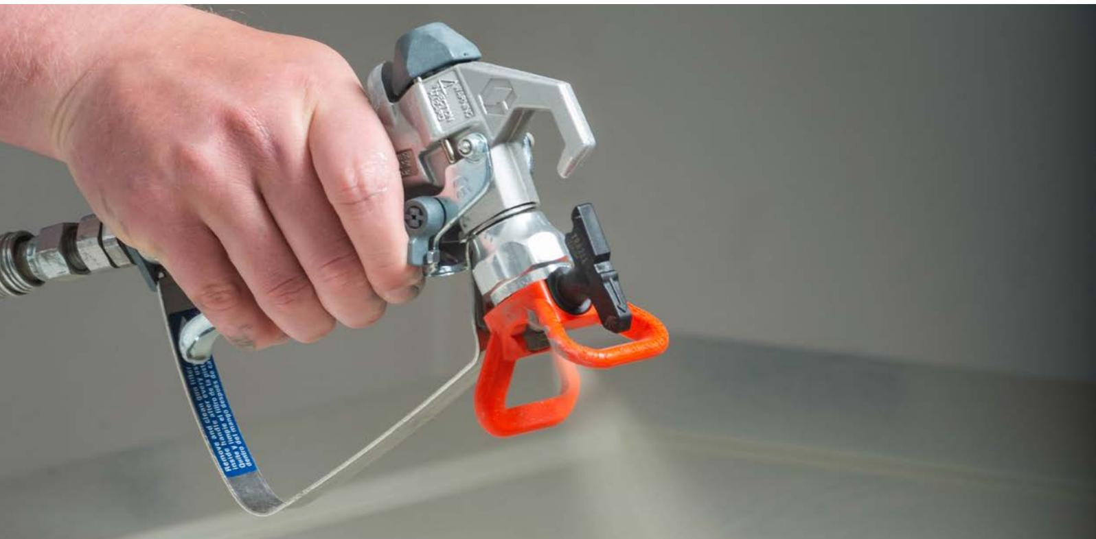
La boquilla de pulverización indica a la bomba la intensidad con la que debe trabajar para mantener la presión necesaria. Garantiza que la pintura se atomice según un determinado ancho de abanico y caudal: un efecto similar a colocar el pulgar en el extremo de una manguera de jardín.
